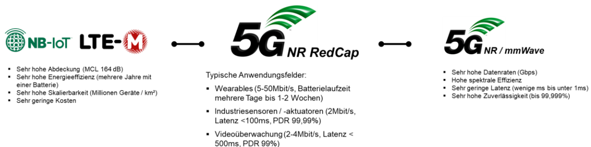
Abbildung 1: 5G NR RedCap schließt die Lücke zwischen NB-IoT/eMTC und 5G NR
