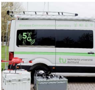
Das Einsatzmobil der TU Dortmund unterstützt inzwischen den neuen Mobilfunkstandard 5G. Neben zwei leistungsstarken Antennen auf dem Dach gehören auch verschiedene Drohnen zur Ausrüstung.
